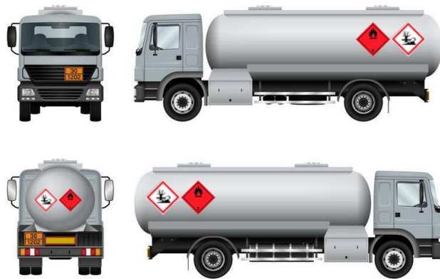
Εικόνα 7 : Τοποθέτησης ετικετών κινδύνου σε βυτιοφόρο όχημα μεταφοράς εύφλεκτων ουσιών (πετρέλαιο). (Πηγή: drivenews.gr)
