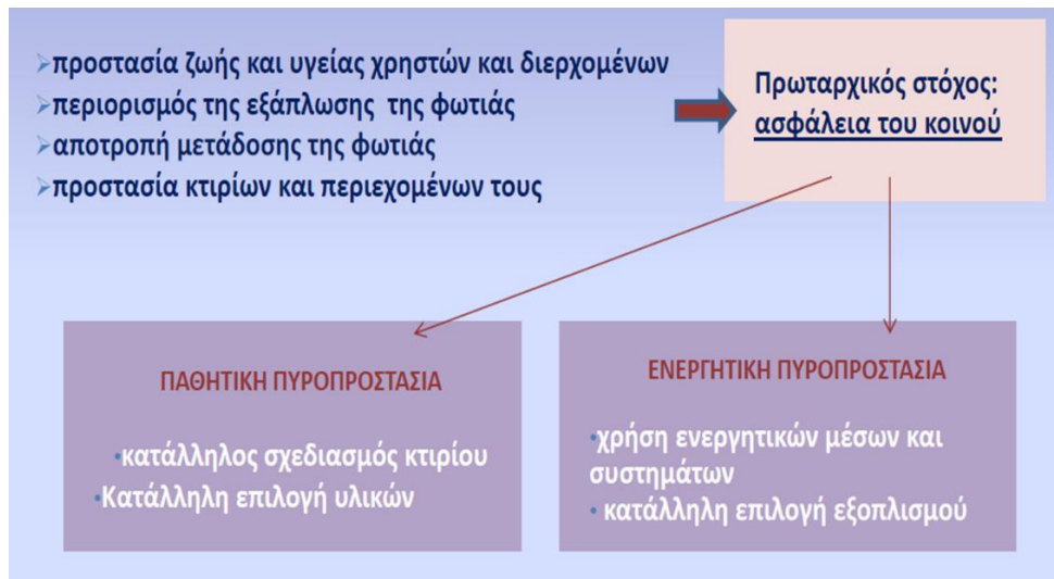
Εικόνα 8. Τα μέτρα πυροπροστασίας
