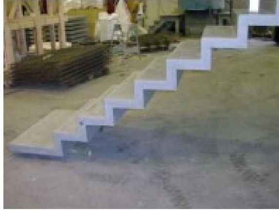
Εικόνα 177: Κλιμακοστάσιο κατασκευασμένο αποκλειστικά από συμπαγές οπλισμένο σύνθετο, χωρίς δοκό στήριξης (Πηγή: Λιόλιος, 2019)
