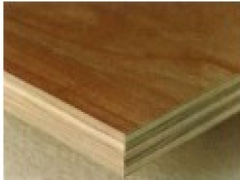
Εικόνα 181: Τυπικό κόντρα πλακέ με καπλαμάδες (Πηγή: Λιόλιος, 2019)
