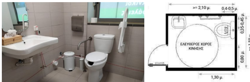
Εικόνα 42. Προσβάσιμος χώρος υγιεινής
