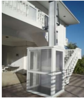
Εικόνα 39. Εξωτερικό αναβατόριο με καμπίνα για πρόσβαση στον όροφο
