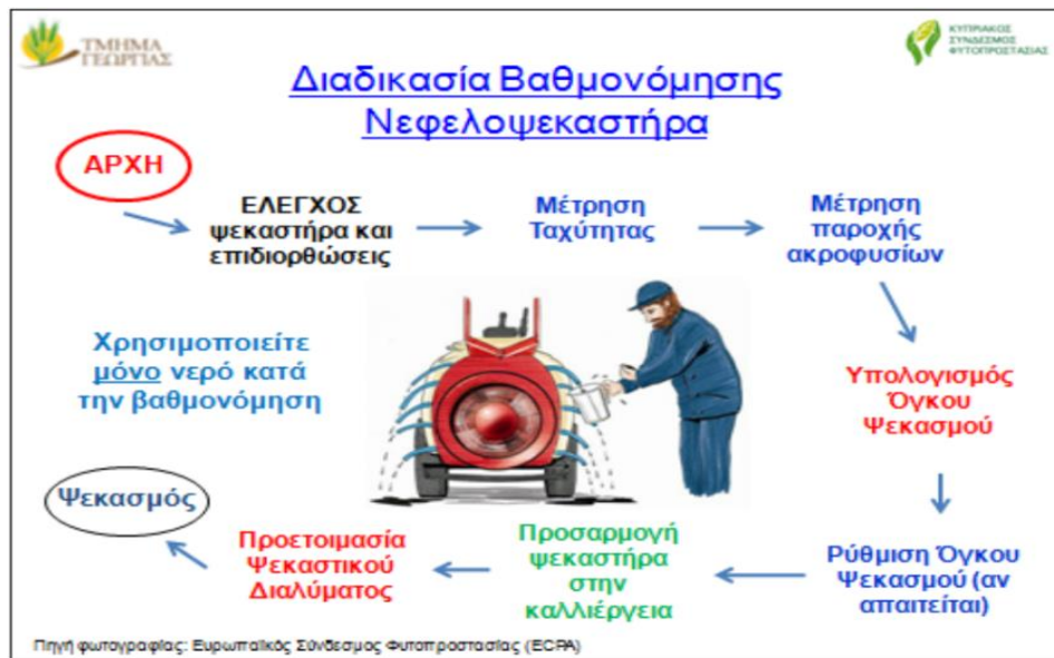
Εικόνα 6.12. Διαδικασία βαθμονόμησης νεφελοψεκαστήρα ( https://www.kysyf.eu/images/pdfs/VathmonomisiNefelopsekastiron.pdf )
