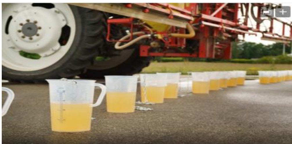
Εικόνα 6.11. Η βαθμονόμηση του ψεκαστικού μηχανήματος διασφαλίζει την αποτελεσματική λειτουργία του (European Commission, 2017)
