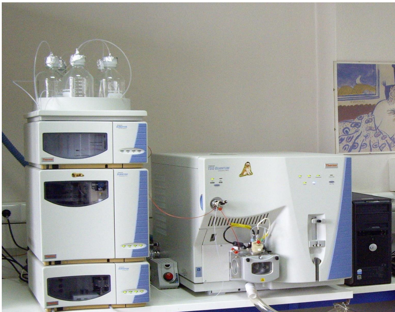
Εικόνα 4.14. Σύστημα γρήρης χρωματογραφίας γρήρης χρωματογραφίας συζευγμένης με διαδοχική φασματομετρία μάζας LC/MS/MS (τριπλο τετράπολο)
