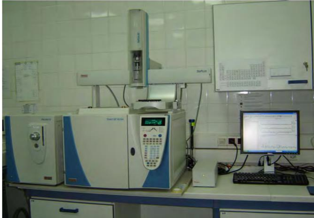
Εικόνα 4.15. Σύστημα αέριας χρωματογραφίας – φασματομετρίας μάζας και συζευγμένης φασματομετρίας μάζας (GC-MS και GC-MS/MS) (Παπαδή-Ψύλλου, 2009)
