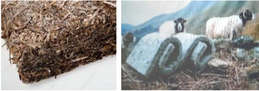
Εικόνα 140: Εναλλακτικά θερμομονωτικά υλικά. Αριστερά χόρτο. Δεξιά μαλλί προβάτου.
