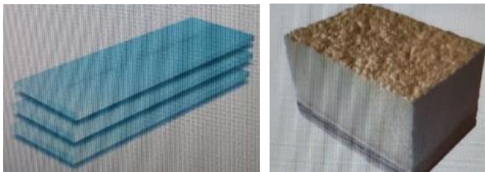
Εικόνα 135: Θερμομονωτικά υλικά για τη μόνωση κτιρίων. Αριστερά εξηλασμένη πολυστερίνη. Δεξιά πολυουρεθάνη.
