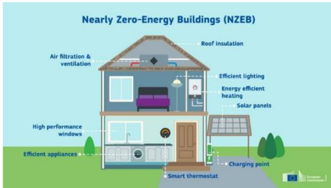
Εικόνα 62: Κτίριο σχεδόν μηδενικής κατανάλωσης ενέργειας
